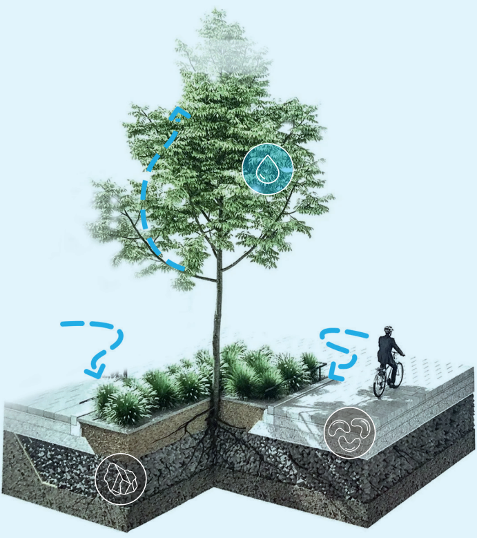
Eine Baumrigole ist ein Hybrid aus einer Versickerungsrigole nach DWA-Merkblatt 138 und einer Pflanzgrube nach der FLL-Pflanzgrubenbauweise.
